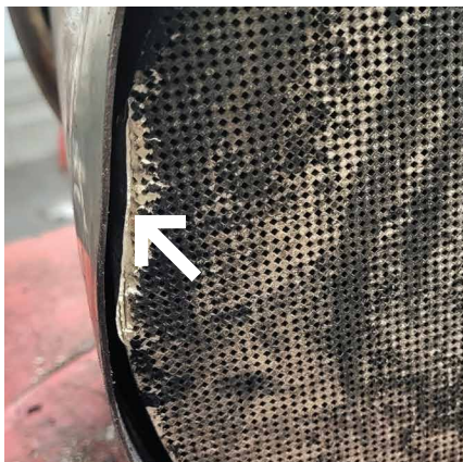
Uszkodzenie mechaniczne obudowy i wkładu
