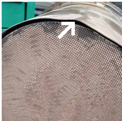
Mechanicznie uszkodzona obudowa SCANIA EURO 6
